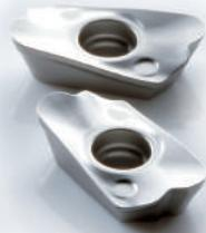
・コーナR=R2以上のインサートを使用する場合、カッタボディのコーナ部を修正する必要があります。ボディ側のコーナR = インサートのR - 1 (例: インサートR3の場合ボディにはR2のR)
