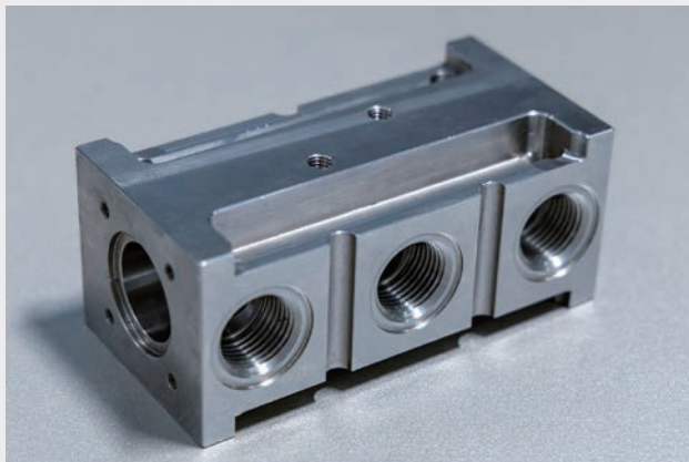
油圧システムの主要な構成部品であるステンレス鋼（SUS316L）製油圧ディストリビュータ。油圧ディストリビュータには2種類の止り穴が計12穴と、直径13mmの通り穴が5穴あります。
