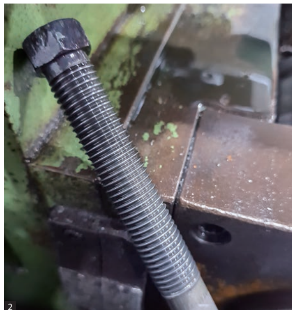
1. Hassmann 社のねじの転造加工は、高出力の油圧式ねじ転造盤を使用して量産されています。材料に M16 × 2 のねじ山を形成するために、転造丸ダイスが取り付けられています。
