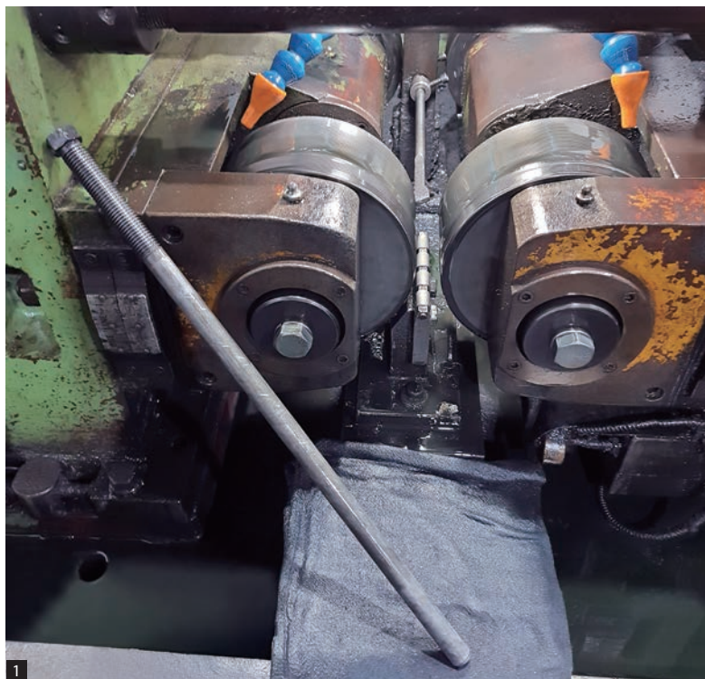
1. Hassmann 社のねじの転造加工は、高出力の油圧式ねじ転造盤を使用して量産されています。材料に M16 × 2 のねじ山を形成するために、転造丸ダイスが取り付けられています。
