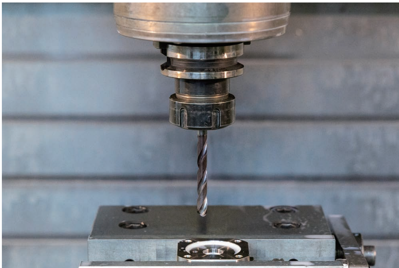
油穴付き超硬ドリル ADO-SUS は、ステンレス鋼およびチタン合金の用途で優れた性能を発揮するように設計されたオーエスジーの最新技術の一つです。
