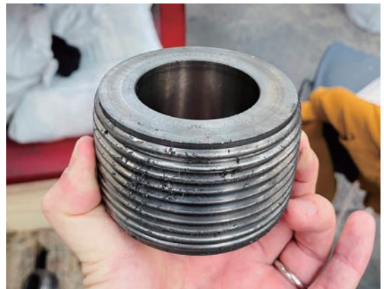
オーエスジー製 M42x4.5 用ねじ転造丸ダイス。ねじ転造丸ダイスは、様々な精密ねじ部品の転造加工に最適です。ねじ転造丸ダイスは、2個または3個セットで使用されます。オーエスジーでは、ご希望の仕様に合わせたカスタマイズにも対応します。
