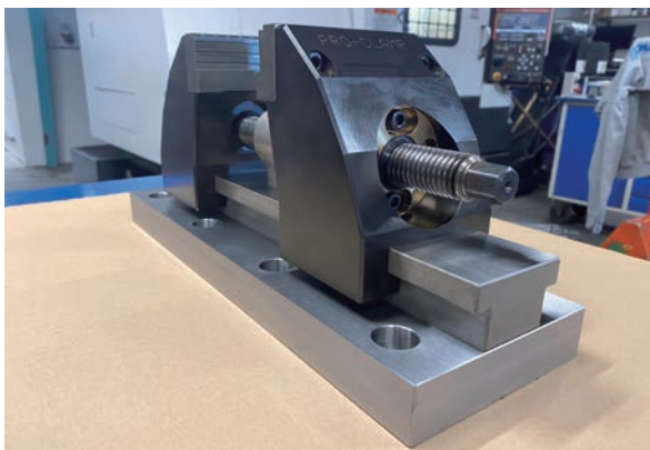
Polund 社製の PRO-CLAMP 5 軸バイスは、クランプ距離が長く、5 軸加工に関連するあらゆるクランプに最適です。
