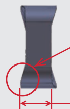
大きなすくい角の ブレイカ Chip breaker with a large rake angle
