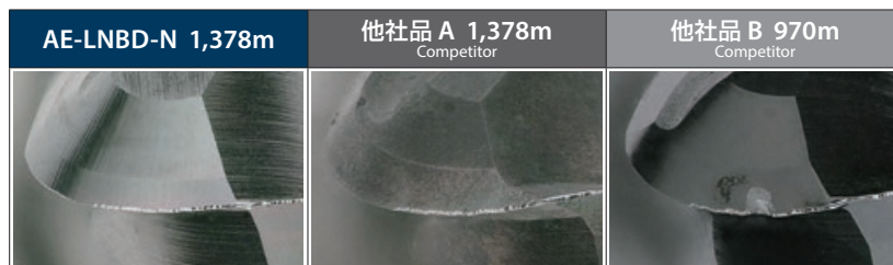
ボール部逃げ面摩耗状態 Wear condition of ball flank
