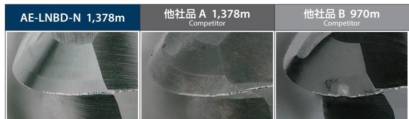
ボール部逃げ面摩耗状態 Wear condition of ball flank
