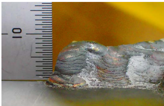
図3 DED法で堆積されたSKD11(60HRC)の写真
