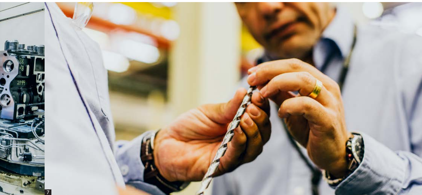
7. 直径 8 mm の油穴付き超硬ドリル ADO-30D を確認する MWM 社のプロセスエンジニアタルチシオ・ポッターニ氏。
