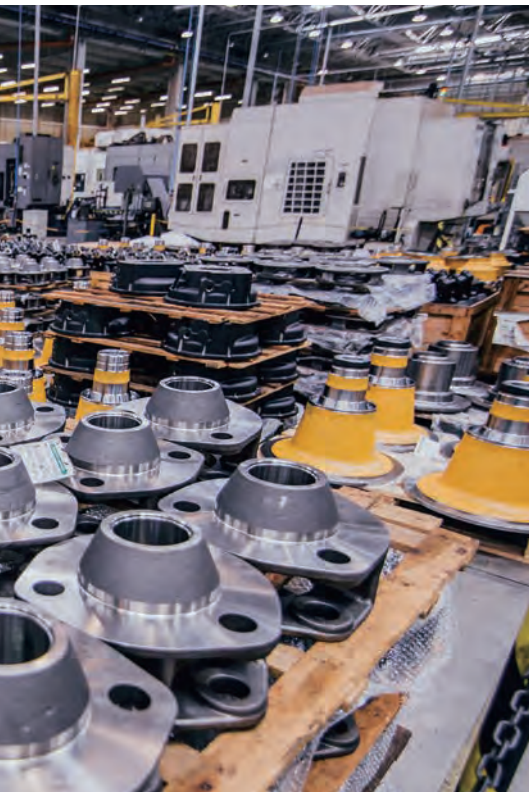
3. A-SFT は、工具寿命を 20% 延ばすとともに、1 部品当たりの加工時間を 4 秒短縮することができました。年間生産数が 78,000 個の場合、加工時間を年間 312,000 秒、すなわち 5,200 分短縮することができます。
