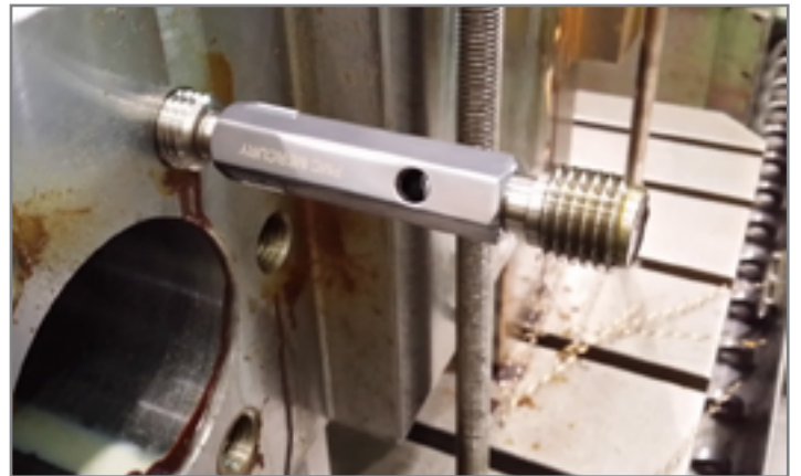
ねじ面の精度と仕上がりを確認するため、FMC 専用の 1" -8UNC GO プラグゲージを使用しました。A-SFT でタップ加工したねじ溝は、高品質な外観に仕上がりました。
