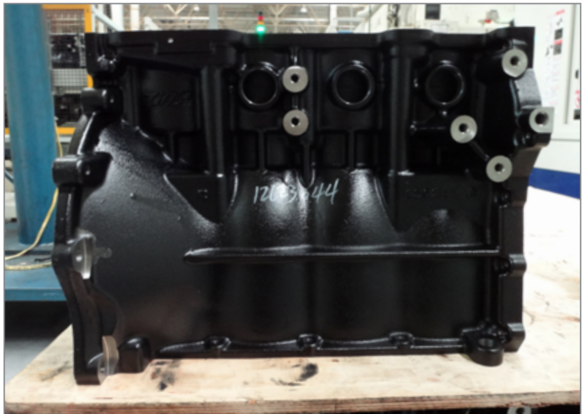
硬度180~220のHT250(FC250と同等)で作ったシリンダーブロック
