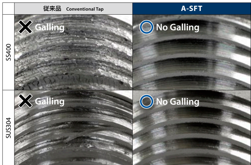
※めねじの加工イメージであり、仕上がりは加工状況により異なります Visual reference of internal threads. Result may differ based on actual machining condition.
